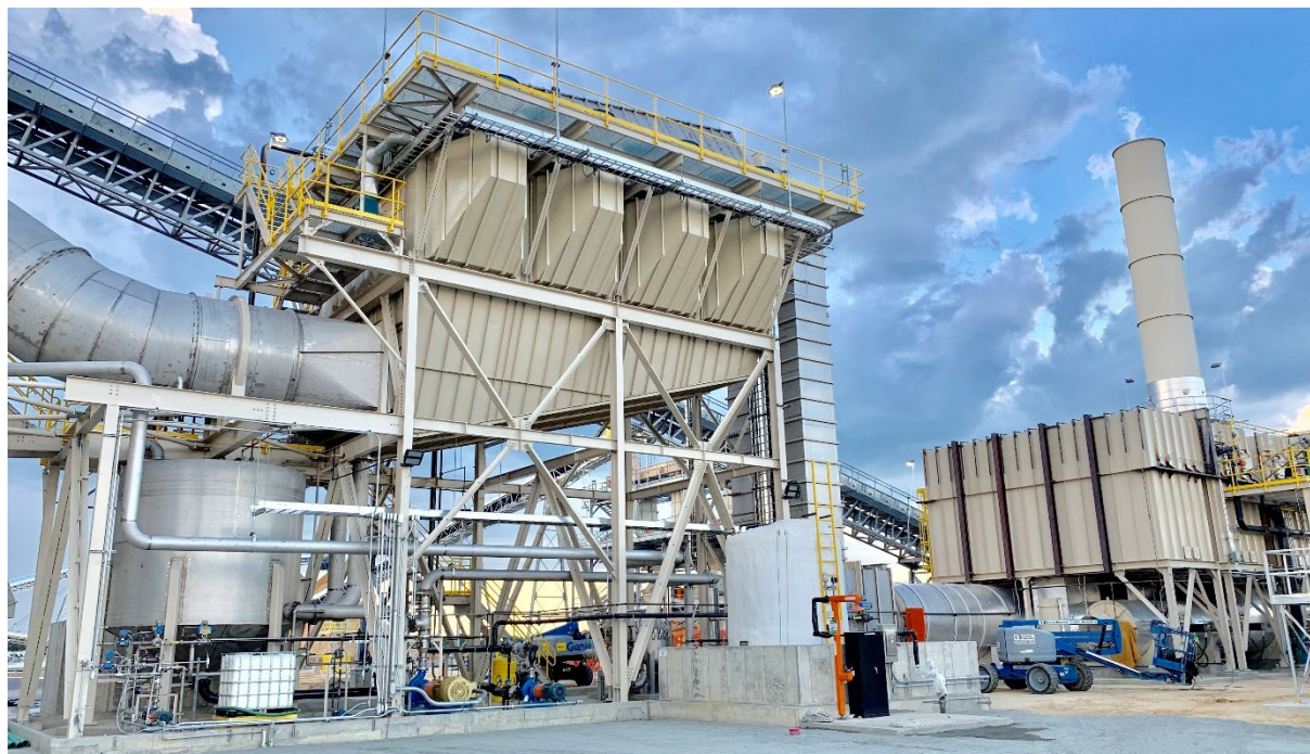
WESP- und RTO-Anlagen in einem Pelletwerk in Hamlet, NC, USA
